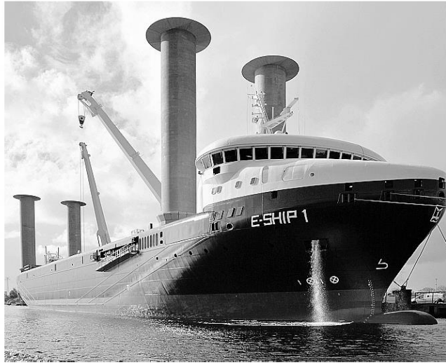
La rotonave E-Ship 1 a «effetto Magnus» (2010), esempio di trasporto ecologico via mare
